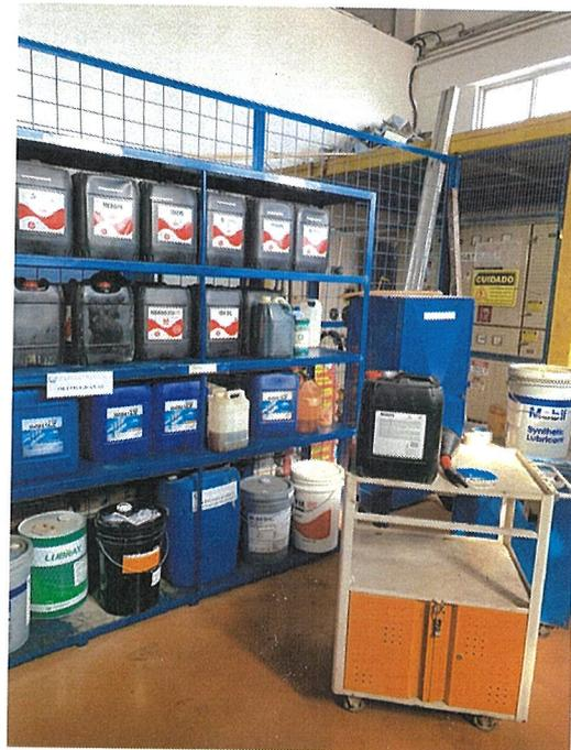
Material inflamável estocado próximo ao quadro elétrico
